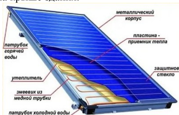
Рис. 1 - Конструкция плоского солнечного коллектора
